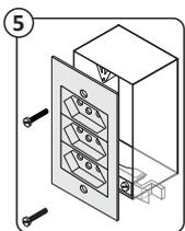
5 Após se certificar que o reparo esta fixado, posicione e parafuse o conjunto modular no furo central do reparo.
