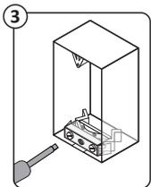
3 Posicione o reparo no local mais adequado e segure-o no momento de apertar os parafusos até que fique firme nas laterais da caixa 4x2.
