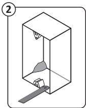
2 Retire a aba quebrada com os devidos cuidados para não danificar os fios. No caso de excesso de concreto ou tubos, remova para posicionar melhor o reparo.
