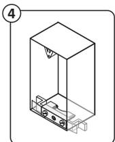
4 Aperte os parafusos das extremidades alternadamente para manter centralizado o furo onde será parafusado o conjunto modular.
